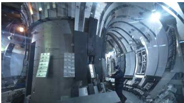
Рисунок 111: Тренировочная модель 1:1 токамака JET (Кулхэм, Великобритания). С сайта [127].
