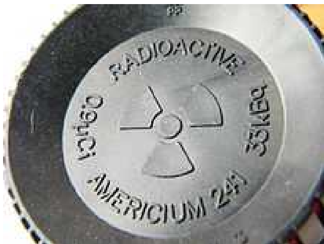
Рисунок 53: Контейнер для амерция-241 в бытовом детекторе дыма. С сайта [56].
