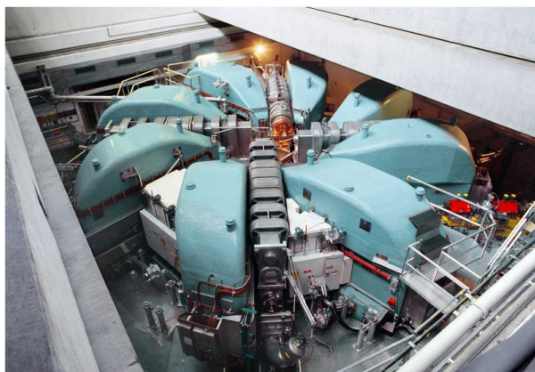
Рисунок 157: Протонный циклотрон Института Поля Шерера, последняя стадия ускорителя протонов. За 186 оборотов в циклотроне протоны разгоняются до 80% скорости света (590 МэВ кинетической энергии). Кожухи магнитов окрашены в голубоватый цвет. С сайта [162].
