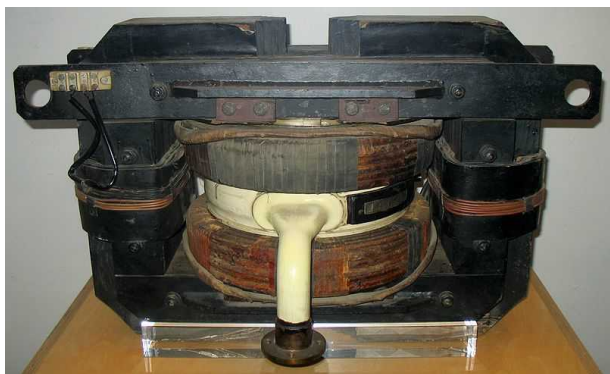
Рисунок 181: Бетатрон, 1942 год. Энергия электронов 6МэВ. С сайта [178]
