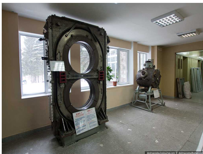
Рисунок 215: Один из первых в мире электрон-электронных коллайдеров ВЭП-1. Единственный в мире ускоритель, в котором пучки вращались в вертикальной плоскости. Энергия пучка 160 МэВ. Работал с 1963 по 1968 годы, сейчас - музейный экспонат. ИЯФ СО РАН. С сайта [206].
