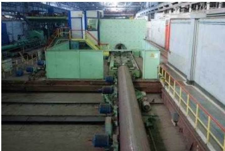
Рисунок 21: Рентгентелевизионный комплекс "Артикон М" для контроля сварных швов. С сайта [24].
