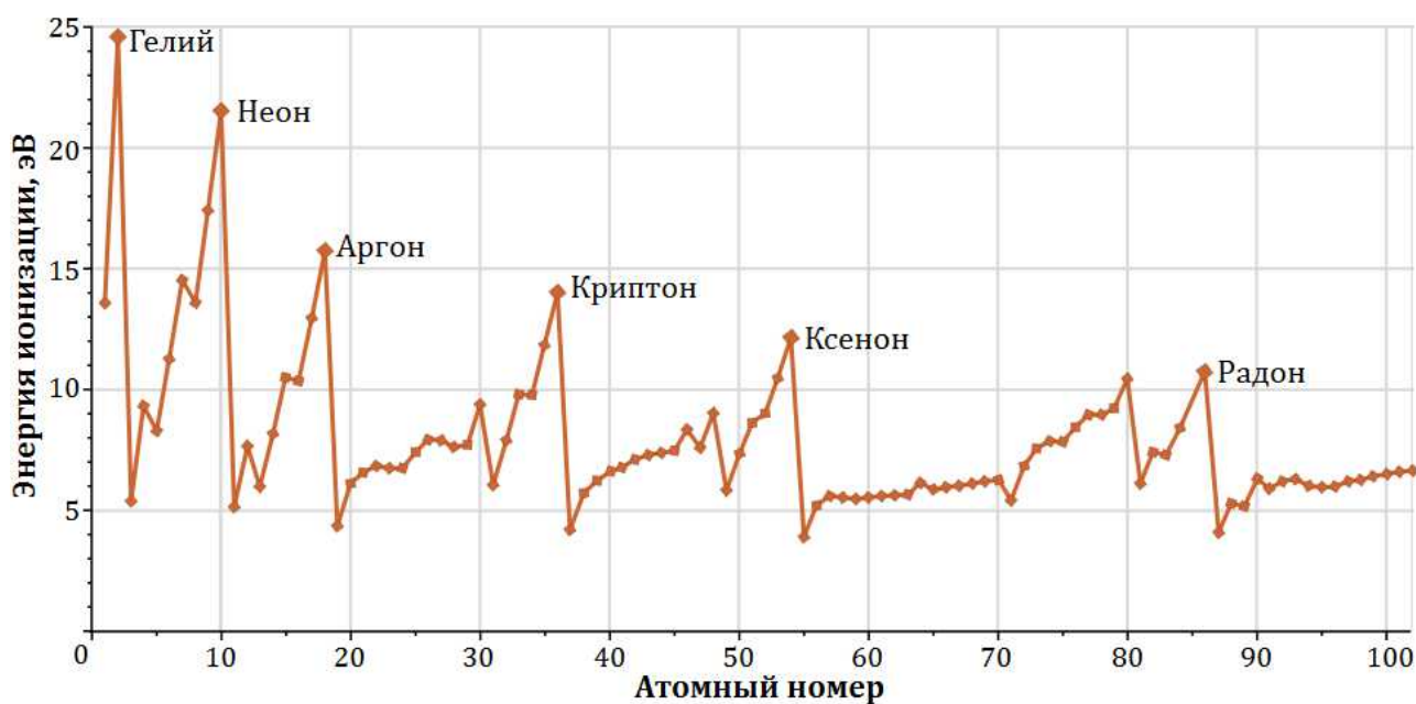
Рисунок 1: Зависимость энергии ионизации от атомного номера элемента С сайта [8].
