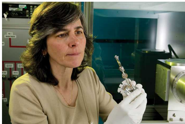
Рисунок 105: Мишень установки NIF (в пинцете держателя). С сайта [123].
