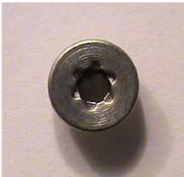
Рисунок 54: Капсула амерция-241 из бытового детектора дыма. Оболочка - алюминий, тёмный элемент в центре - диоксид амерция-241. С сайта [56].
