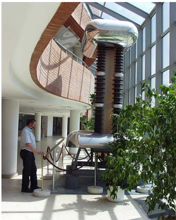
Рисунок 169: Генератор Ван де Граафа первого венгерского линейного ускорителя, в 1952 году достигнуто напряжение 1МВ. С сайта [171].
