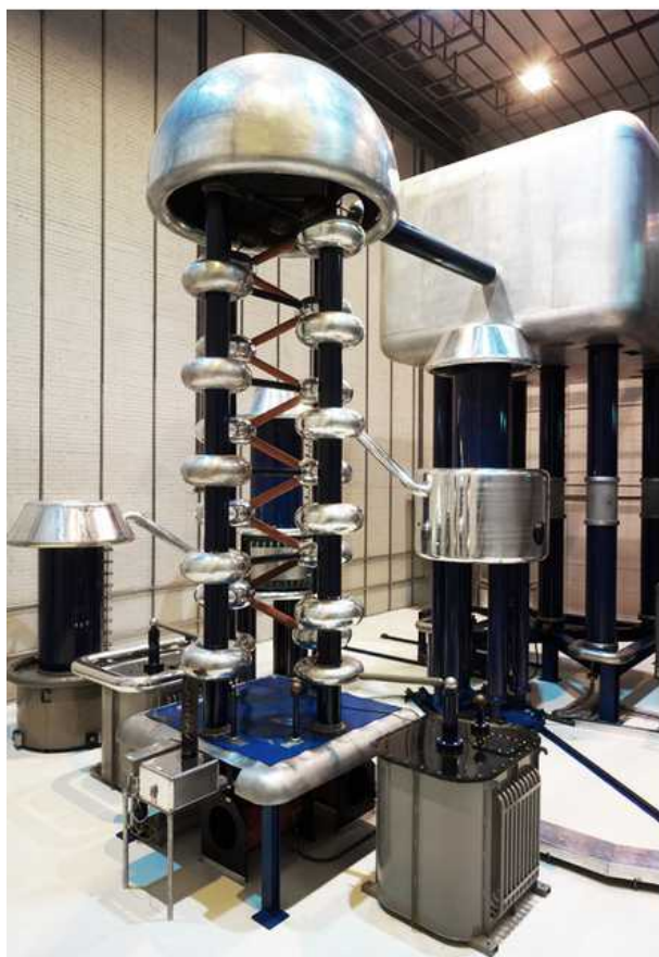
Рисунок 156: Ускоритель Кокрофта-Валтона, первая стадия протонного ускорителя Института Поля Шерера. С сайта [162].
