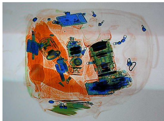
Рисунок 22: Рентгеновское изображение рюкзака при контроле безопасности. Цветная раскраска - результат компьютерной обработки по сравнению изображений на разных длинах волн. С сайта [25]
