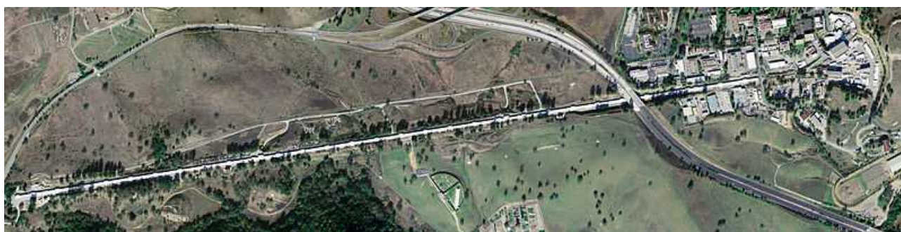
Рисунок 175: Вид с воздуха на комплекс зданий Стэнфордского линейного ускорителя. Детекторный комплекс справа. Сам канал ускорителя находится на глубине 10 метров под землёй. С сайта [175].
