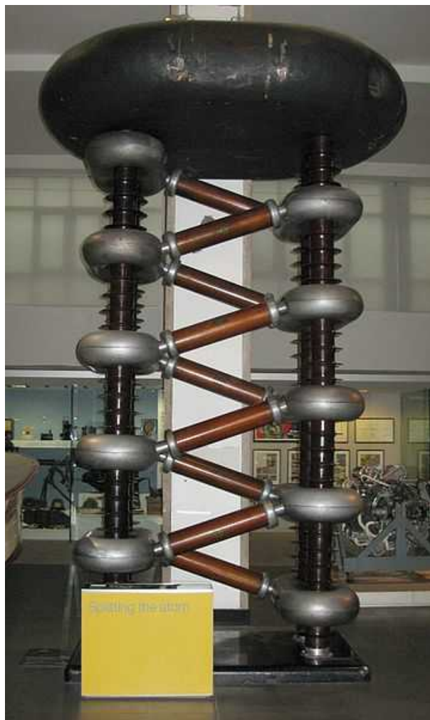
Рисунок 170: Умножитель Кокрофта-Валтона, 1937 год. С сайта [170].
