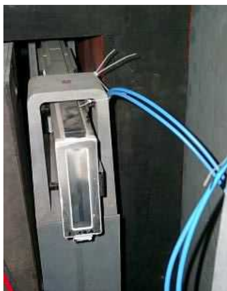
Рисунок 154: Выход нейтроновода к дифрактометру D16 (ИЛЛ, Гренобль, Франция). С сайта [109].
