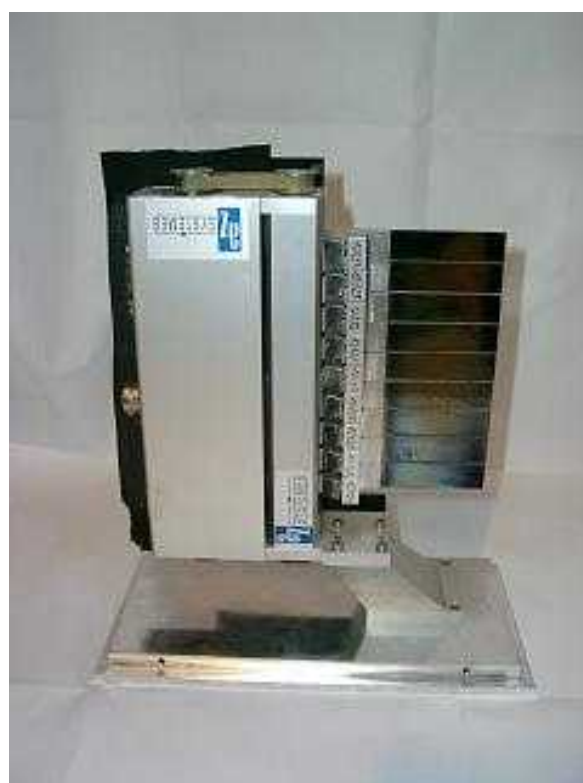
Рисунок 153: Монохроматор из пиролитического графита с дифрактометра D16 (ИЛЛ, Гренобль, Франция). С сайта [109].
