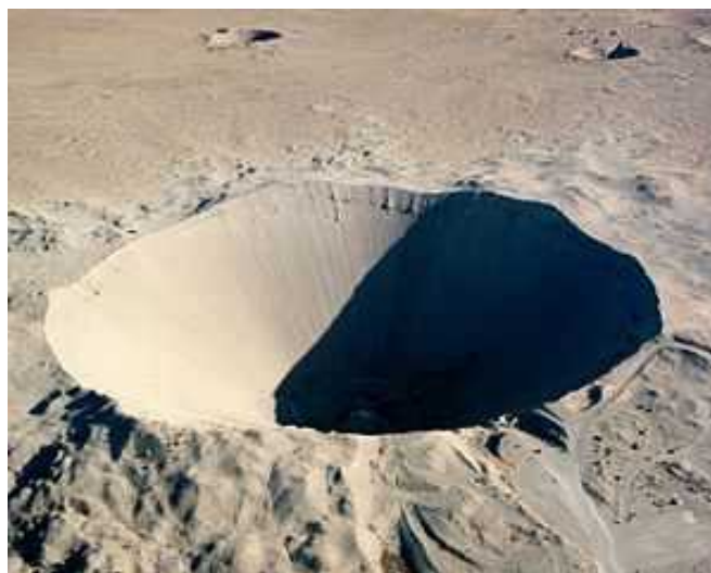
Рисунок 83: Кратер образовавшийся при неглубоком подземном взрыве в Неваде (США) (также известен как "кратер Седан"). В 1962 году при взрыве на небольшой глубине термоядерного боеприпаса мощностью 104 кт тротилового эквивалента. При взрыве образовался кратер 100 метров в глубину и 390 метров в диаметре. С сайта [92].
