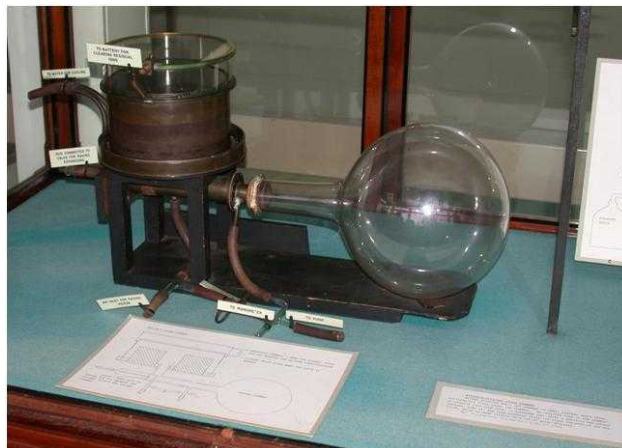
Рисунок 138: Сделанная Ч.Вильсоном камера Вильсона. Из экспозиции музея Кавендишской лаборатории. С сайта [154].
