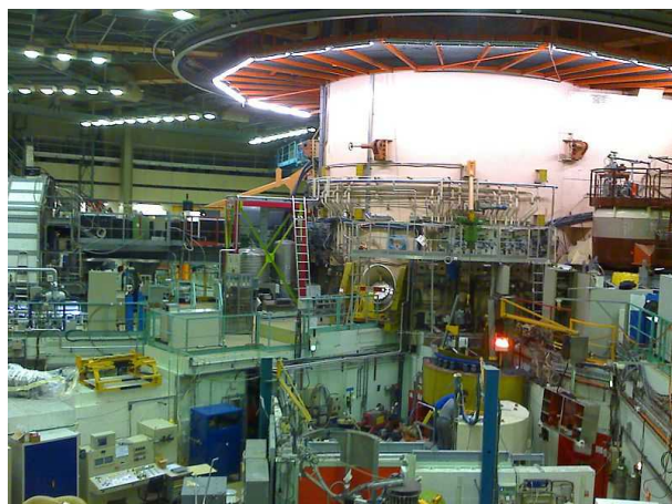
Рисунок 95: Реакторный зал Института Лауэ-Ланжевена. Реактор в центре, вокруг расположено экспериментальное оборудование. С сайта [108].
