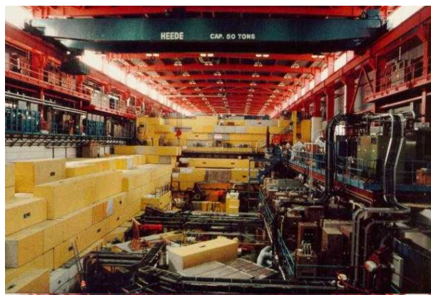
Рисунок 178: Экспериментальный зал циклотрона Триумф (Ванкувер, Канада). Циклотрон на заднем плане скрыт под бетонными блоками толщиной около 5 метров. С сайта [177].
