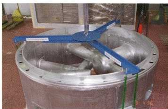
Рисунок 162: Танк замедлителя перед установкой. Внутренний объём (диаметр около 2 метров) заливается тяжёлой водой. С сайта [162].
