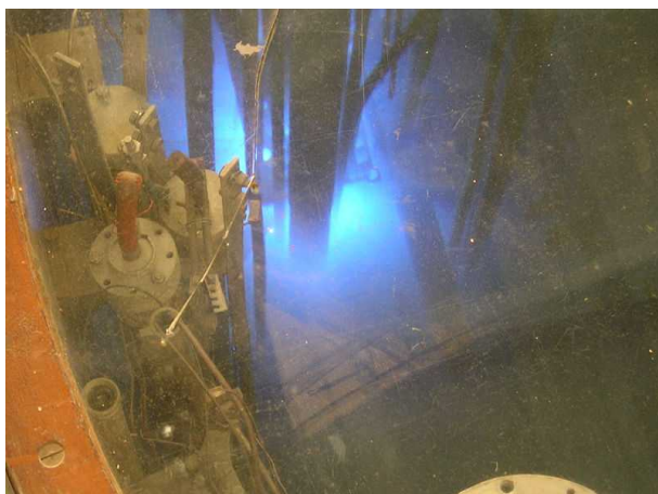
Рисунок 90: Вид на активную зону реактора МИФИ ИРТ-2000. Голубое свечение вызвано черенковским излучением частиц, движущихся со скоростью больше скорости света в воде. С сайта [101].
