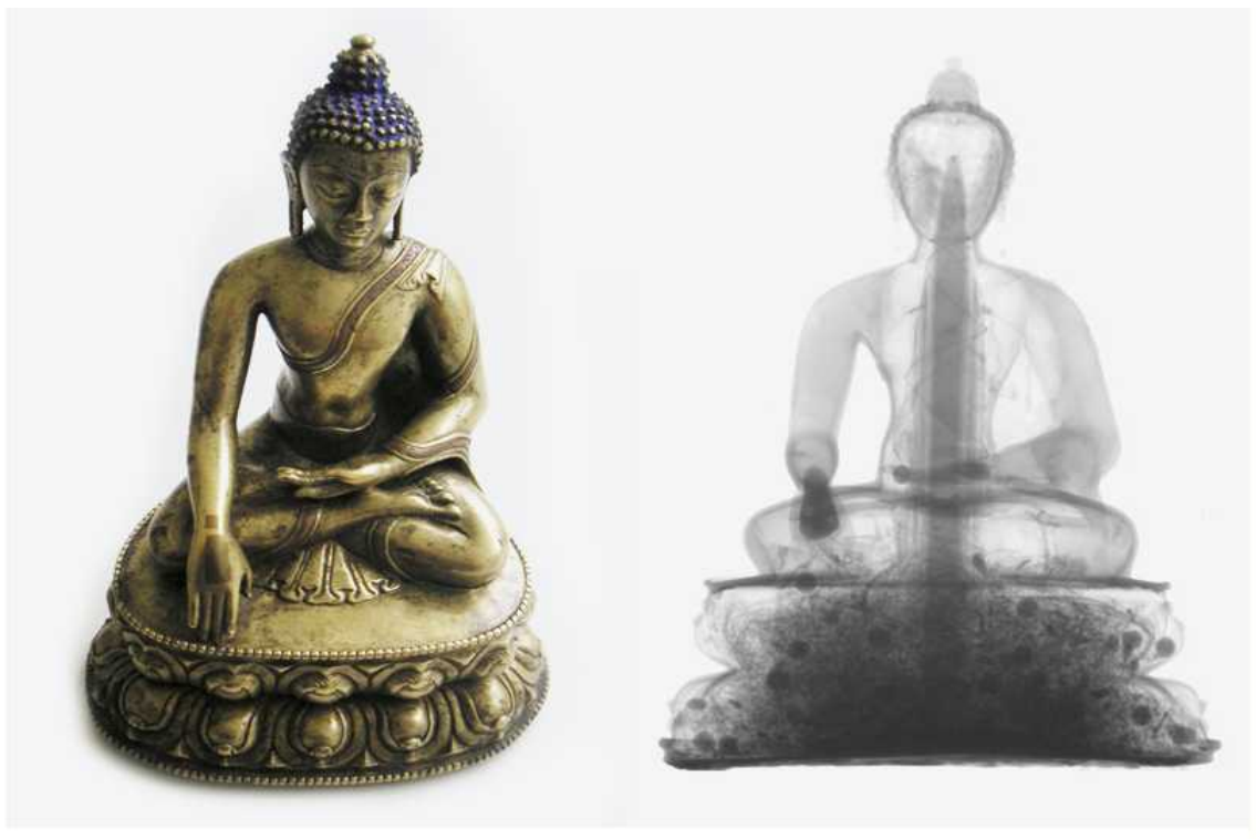
Рисунок 167: Бронзовая статуэтка 15 века (Тибет) и её нейтронная радиограмма, показывающая присутствие внутри фрагментов растений. С сайта [162].
