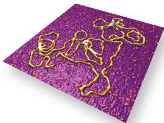
Рисунок 35: Изображение молекулы ДНК, полученное атомным силовым микроскопом. Размер области сканирования 530 нм. С сайта [33].
