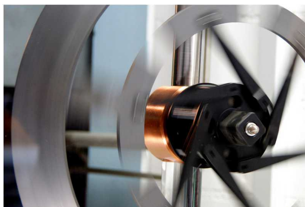
Рисунок 158: Вращающаяся углеродная мишень для мюонного генератора Института Поля Шерерра (Виллиген, Швейцария). С сайта [162].
