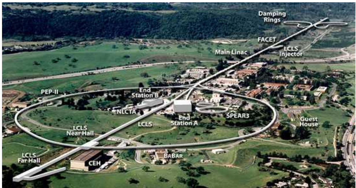
Рисунок 200: Схема расположения ускорителей центра SLAC. С сайта [197].
