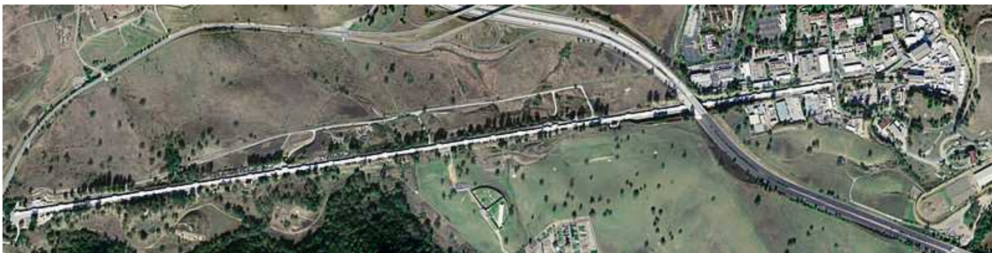
Вид с воздуха на комплекс зданий Стэнфордского линейного ускорителя. Детекторный комплекс справа. Сам канал ускорителя находится на глубине 10 метров под землёй. http://en.wikipedia.org/wiki/Stanford_Linear_Accelerator_Center
