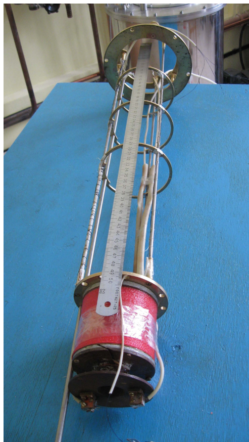
2013-03-06. Сверхпроводящий соленоид на подвесе перед установкой в криостат. Также видны токовводы (пара проводов справа, будут заменены после аварийного расплавления в 2014), трубка для дренажа азота (слева), провод уровнемера (проклеен по левой стойке каркаса)
