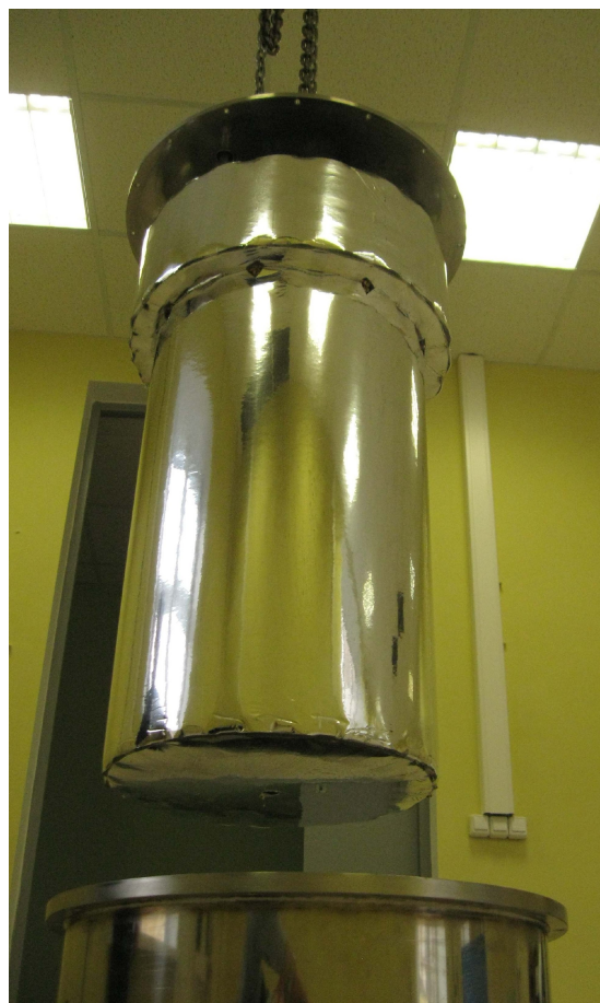
2012-11-08. Вид на покрытую многослойной "суперизоляцией" внутренность криостата.
