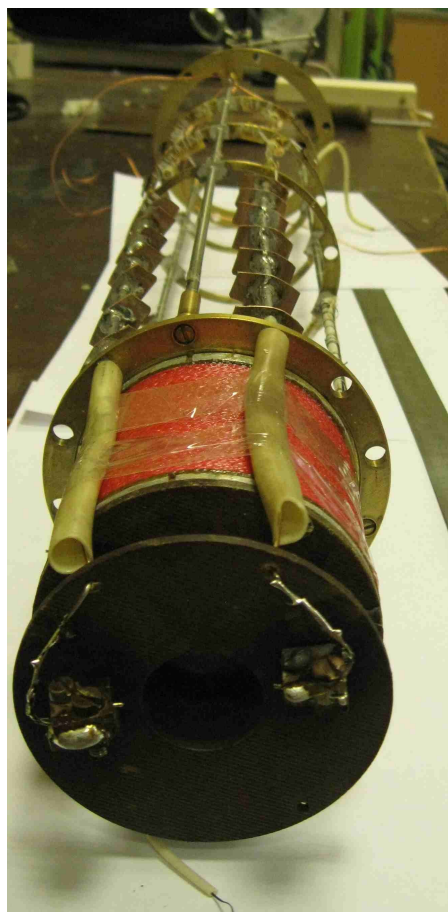
2014-02-17. Новые токовводы с дополнительными экранами для теплосъёма. Новые токовводы в низкотемпературной части - медный провод диаметром 0.8 мм с параллельно пропаянной сверхпроводящей проволокой.
