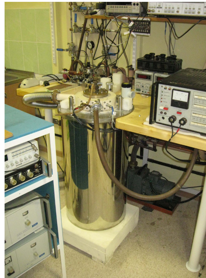
2014-01-28. После полугода работы. Также видны подключения к возвратной гелиевой сети и откачному насосу, источник тока для сверхпроводящего соленоида, насос, различная измерительная электроника.
