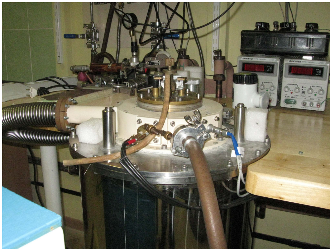
2014-01-28. "Голова" криостата крупным планом. После полугода работы краска чуть облезла - но в остальном полёт нормальный.
