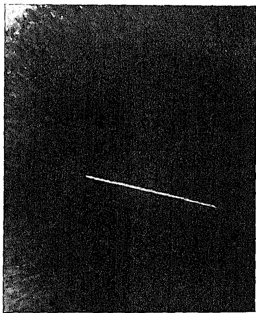
Рис. 3. Фотографии следов сильно ионизующих частиц в диффузионно-конденсационной камере. a — непрерывное освещение, экспозиция \frac{1}{2} сек., b — освещение импульсной лампой
